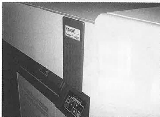
▲北大方正のシステムのフィルム出力は、AGFA SelectSet 5000で行われている。3,600dpiで美しいフィルムが出力されてくる。
